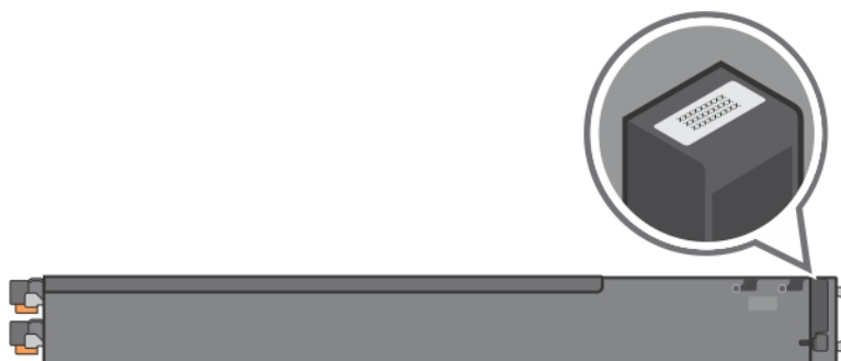
图 39: 左前面板上的服务标签位置
