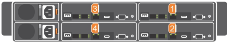
图 4: 1U 节点的四系统板枚举
